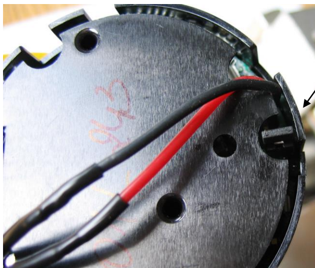
Rys.5. Widok zwory układu podświetlenia wyświetlacza w zespole elektroniki (tylna strona modułu wyświetlacza).
