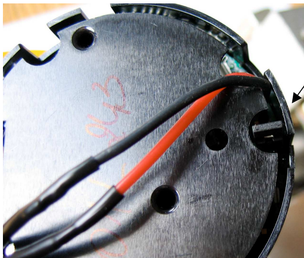
Rys.5. Widok zwory układu podświetlenia wskaźnika w podzespołe elektroniki (tylna strona zespołu wskaźnika)
