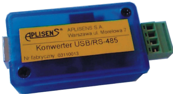
RYS.2 Zaciski wyjściowe konwertera – widok od strony podstawy obudowy.
